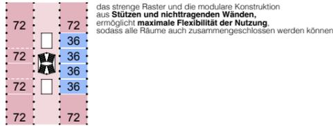
das strenge Raster und die modulare Konstruktion aus Stützen und nichttragenden Wänden, ermöglicht maximale Flexibilität der Nutzung, sodass alle Räume auch zusammengeschlossen werden können
